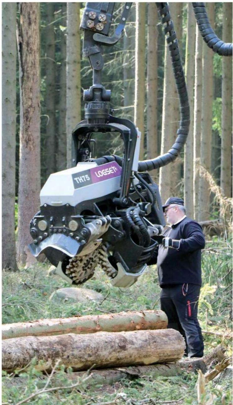
Logset 8H GTE Hybrid lze vybavit harvesterovou hlavicí Logset TH55, TH65 nebo TH75.
